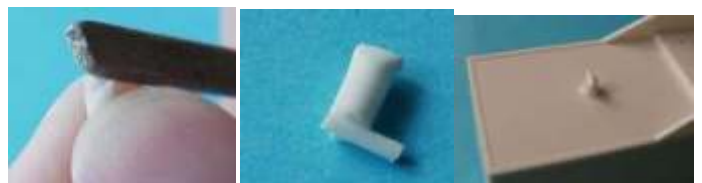
Der Königszapfen: 2,5mm Rundstab kerben, Stück 1mm Rundstab kleben und dann das ganze in das Loch der Grundplatte kleben.
