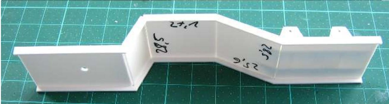
Die Bodenplatten werden von der Mitte aus beginnend von unten an die Hilfsrahmen geklebt. Die Teile 23-26 mit den Teilen 14 und die Teile 27-31 mit den Teilen 15.
