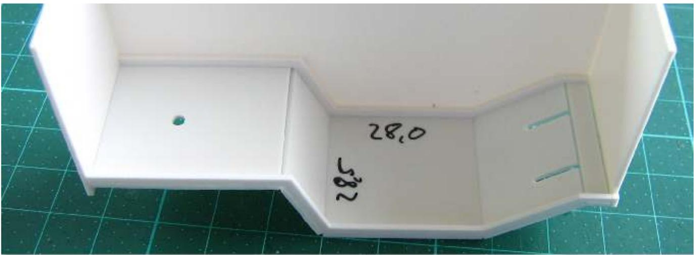
Beim Einkleben der Chassisteile ist darauf zu achten, daß es hinten unten bündig abschließt, aber vorn 2mm tiefer drin sitzt. Das ist eine kosmetische Maßnahme zur besseren Optik. Das gilt für beide Chassisteile.
