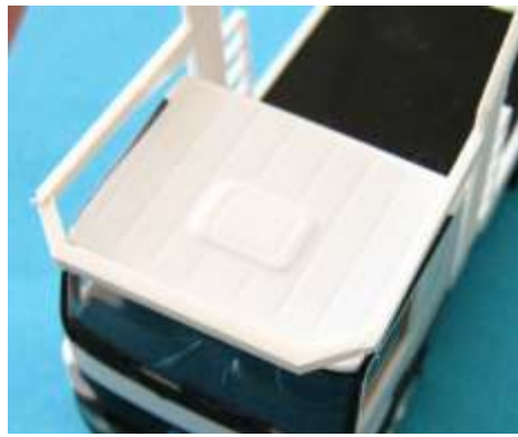
Quertraverse vorn einkleben und die Ecken bündig feilen.
